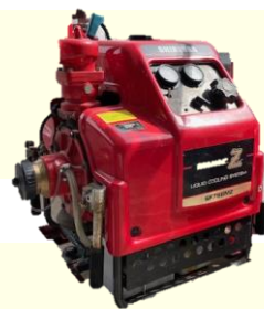
②可搬ポンプ ※バッテリー切れ
